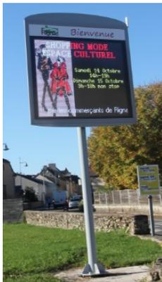
Le modèle retenu est un panneau lumineux double face donc visible dans les 2 sens de circulation, à led couleur avec une dimension d'affichage de L 128\*H96 cm pour un meilleur confort visuel.
